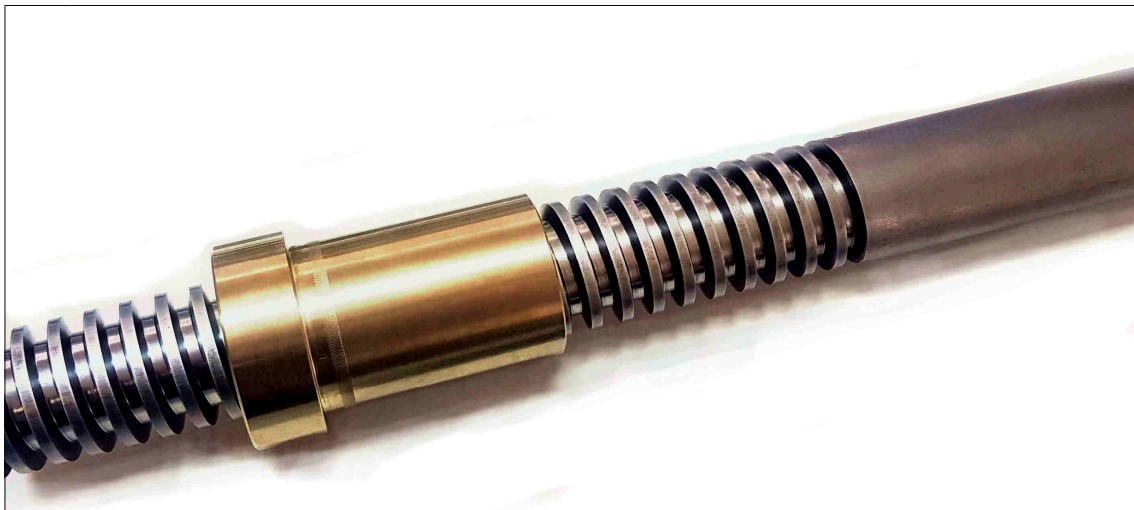
Esempio di accoppiamento chiocciola e barra filettata TR 50x12 con codolo cilindrico a diametro della vite.
